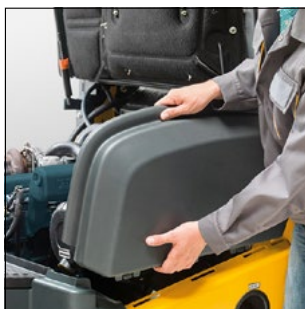
Rimozione parti laterali semplice e senza attrezzi.
