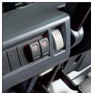
Freno di parcheggio elettrico attivabile tramite pulsante.
