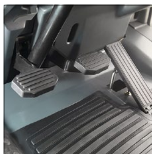
Pedali con assetto automobilistico e superficie antiscivolo.
